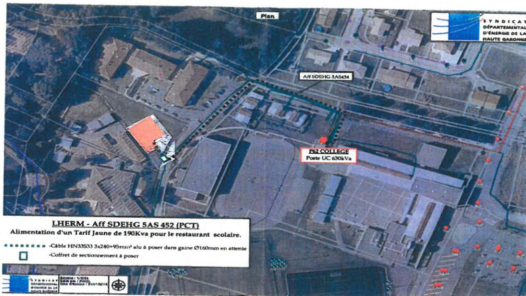
M. PASIAN précise qu'il est impossible de se raccorder aux coffrets devant le gymnase, du fait des puissances maximales pouvant être appelées par le fonctionnement du restaurant scolaire. Le réseau électrique sera raccordé sur celui du collège.
