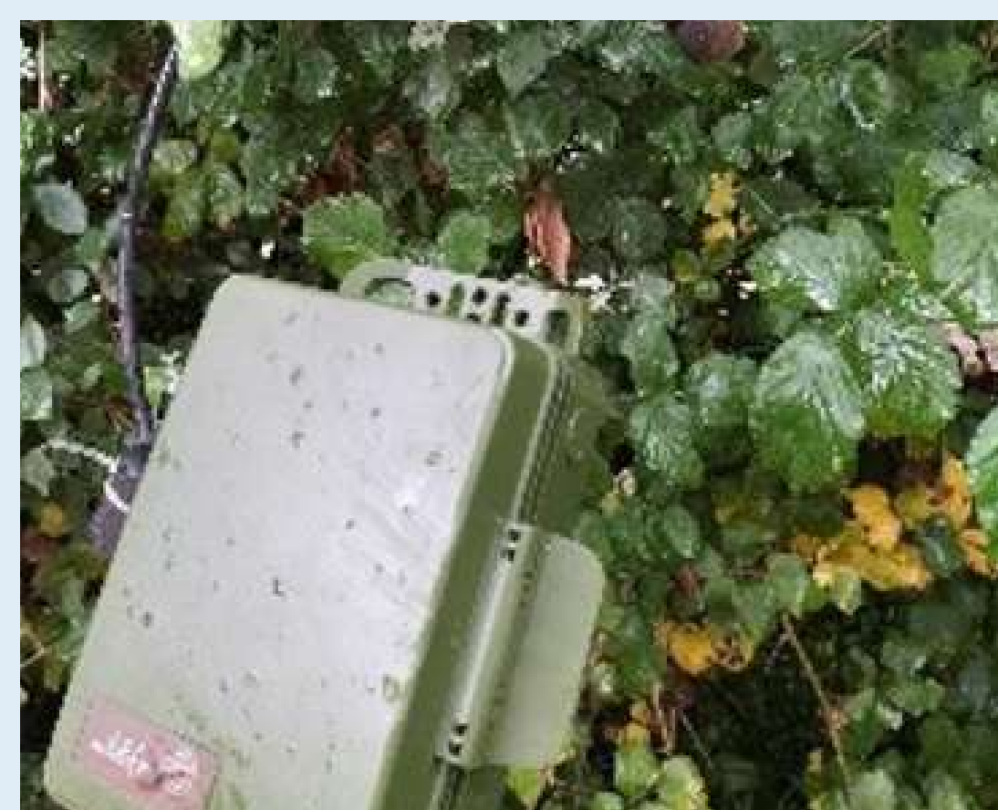
Installation d'enregistreurs et de micros et points d'écoute pour le suivi des chiroptères (chauve-souris).
